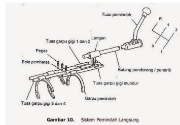
Gambar 10. Sistem Pemindah Langsung
