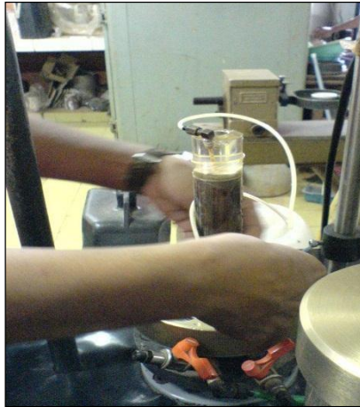
Gambar 2.4 Proses pemasangan sampel uji ke alat triaksial
