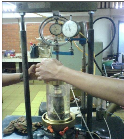
Gambar 2.5 Proses pengisian sel triaksial dengan gliserin/air
