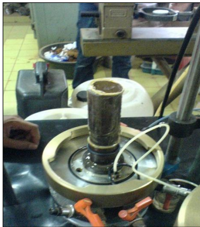
Gambar 2.3 Sampel uji yang telah terpasang membran karet
