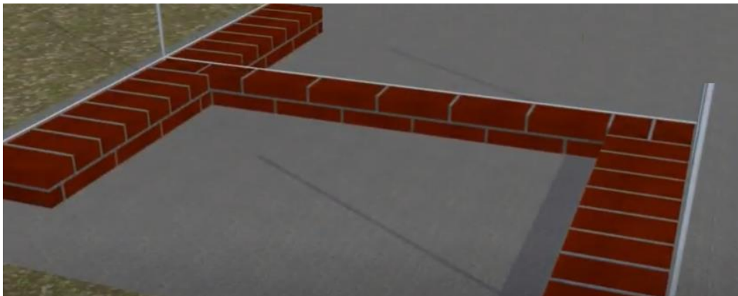
Gambar Penyusunan batu bata untuk lapisan kedua
