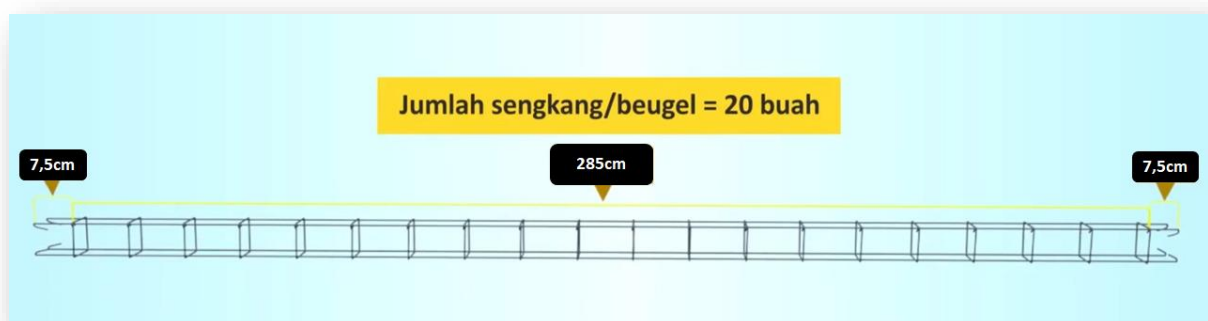
Gambar Hasil Akhir Tulangan Sloof/Kolom/Balok
