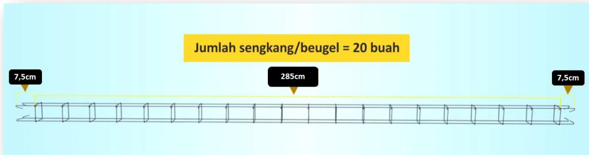
Gambar 18. Pengikatan besi tulangan dengan tulangan begeul
