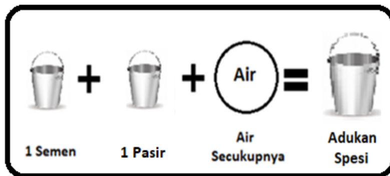
Gambar Pembuatan Adukan Spesi Porselin Dinding
